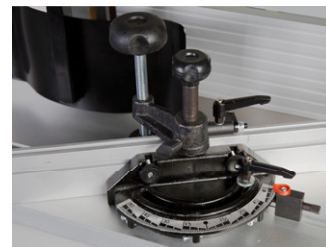
Plynule nastavitelný úhlový doraz
